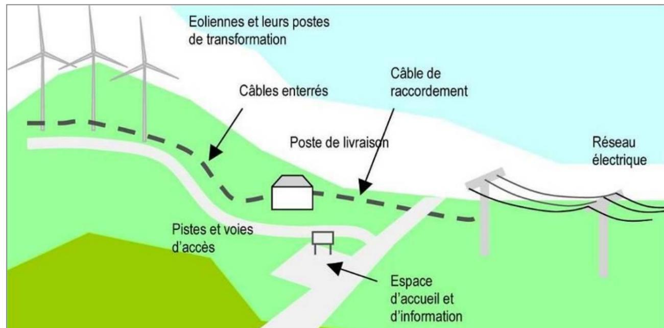
Figure 64 : Schéma de principe d'un parc éolien (Source : Guide de l'étude d'impact sur l'environnement des parcs éoliens, 2010)
